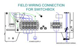
NOTE: MAKE SURE THE WIRES DOES NOT TOUCH ANY COPPER PIPE.
